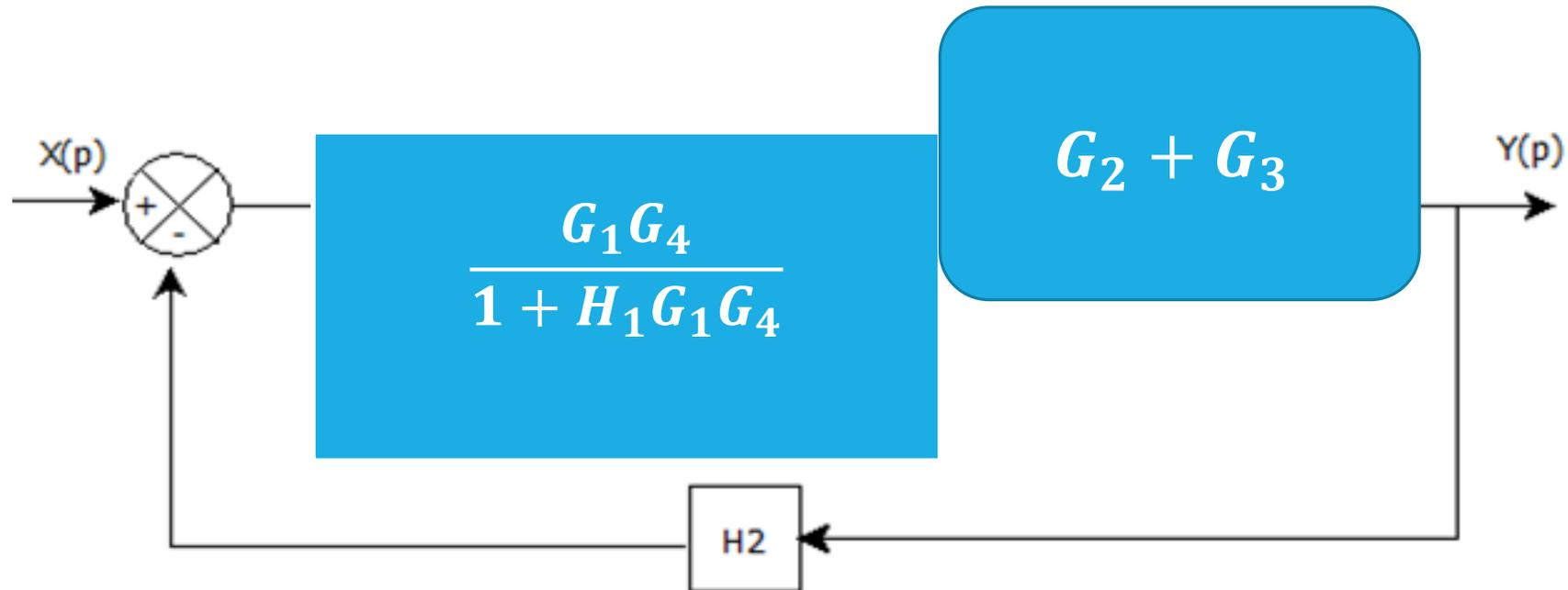
$$H(p) = \frac{Y(p)}{X(p)} = \frac{\frac{(G_2 + G_3)G_1G_4}{1 + H_1G_1G_4}}{1 + \frac{H_2(G_2 + G_3)G_1G_4}{1 + H_1G_1G_4}} = \frac{(G_2 + G_3)G_1G_4}{1 + H_1G_1G_4 + H_2(G_2 + G_3)G_1G_4}$$
