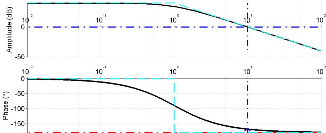
Marge de phase =  $11,47^\circ$  et marge de gain infinie
