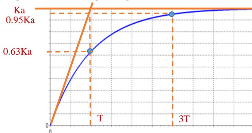
Réponse indicielle pour un échelon d'amplitude a
