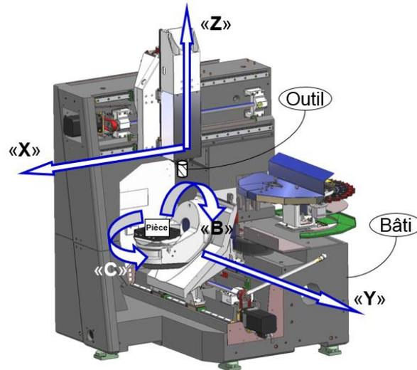
La chaîne cinématique de transformation du mouvement de rotation du moteur de l'axe « Y » en mouvement de translation horizontale est schématisée ci-après.
