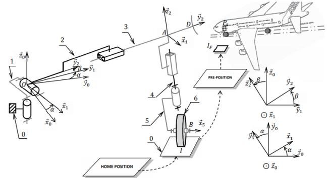
L'effet de l'inclinaison des couloirs est négligé ( $\beta = 0^\circ$ ) et on se place dans le cas où l'angle  $\alpha$  est nul. Le couloir (2) est supposé immobile par rapport au bâti (0). Pour cela, le couloir (3) est supposé en liaison glissière d'axe  $(O, \vec{y}_0)$  avec le bâti (0) et de paramètre de translation  $y(t)$  (voir figure suivante).
