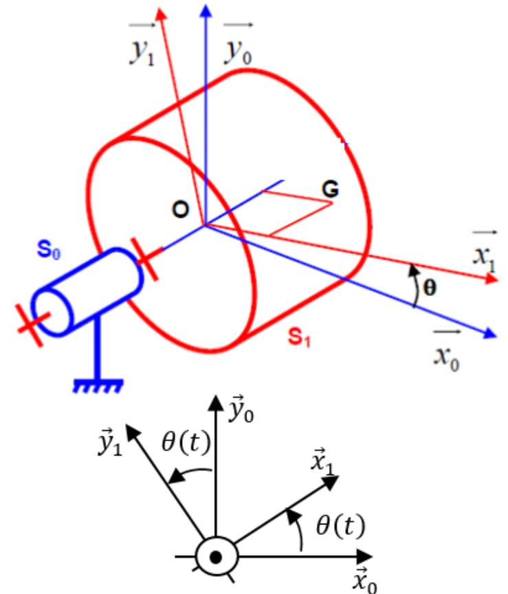
4. Isoler  $S_1$  et Exprimer dans  $R_0$  le torseur des efforts extérieurs appliqués sur  $S_1$  au point O.
