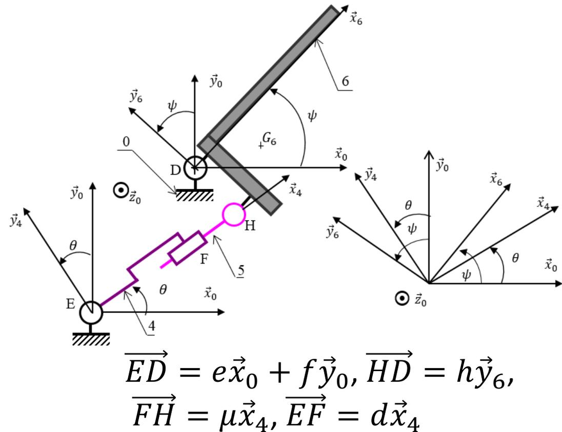
5. Exprimer au point D et dans la base du repère  $R_6$  les éléments de réduction du torseur d'actions mécaniques extérieures au plateau 6. On donne  $\vec{g} = -g\vec{y}_0$ , l'action mécanique de la tige du vérin 5 sur le plateau 6 est donnée par le torseur suivant
