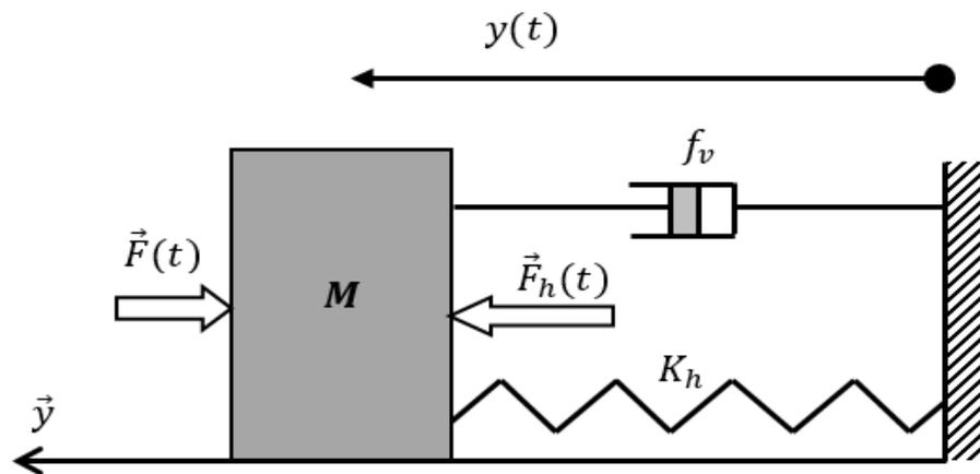
Traduire l'équation de mouvement dans le domaine de Laplace sachant que les conditions initiales sont supposées nulles. Compléter le schéma bloc suivant :
