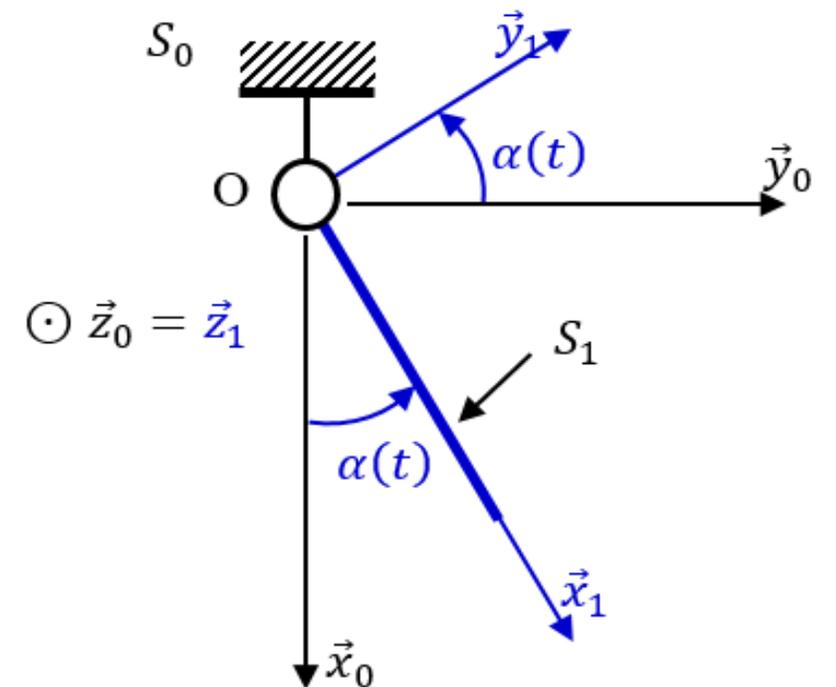
Déterminer, dans la base du repère  $R_0$ , le torseur des actions mécaniques extérieures à  $S_1$ .
