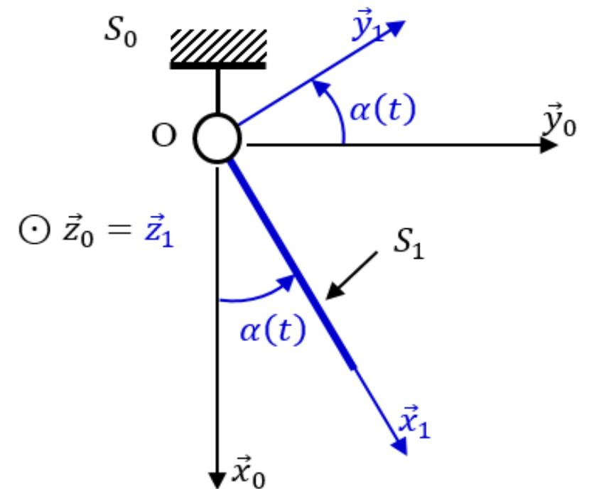
Déterminer, dans la base du repère  $R_0$ , le torseur dynamique de  $S_1$  dans son mouvement par rapport à  $R_0$ .
