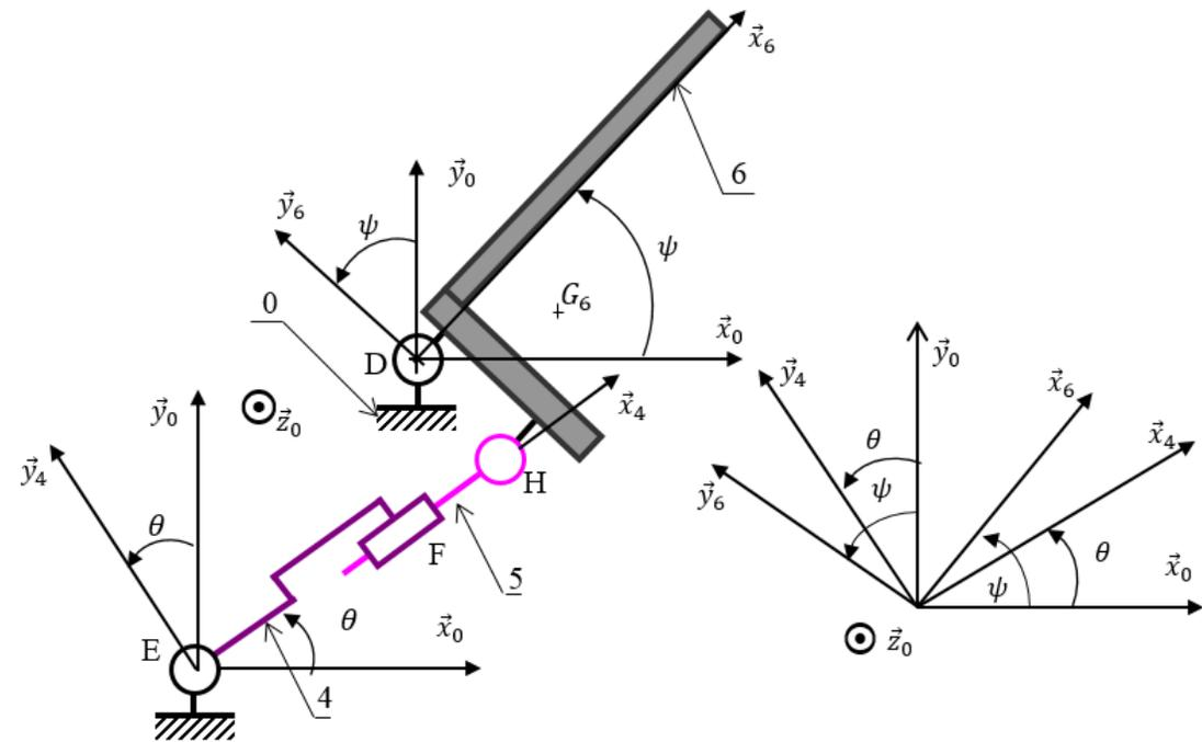
1. Exprimer dans la base de  $R_6$  la vitesse du centre d'inertie  $G_6$  du plateau 6 dans son mouvement par rapport à  $R_0$ .  $\vec{V}(G_6 \in 6/R_0)$  Sachant que  $\overrightarrow{DG_6} = x_G \vec{x}_6 + y_G \vec{y}_6$ .
