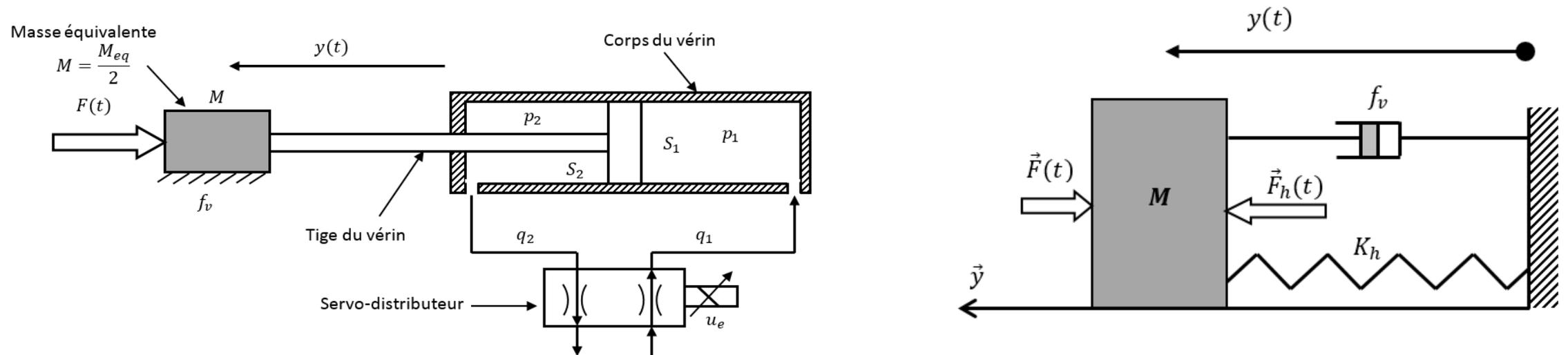
1. En appliquant le théorème de la résultante dynamique en projection sur l'axe  $\vec{y}$ , déterminer l'équation de mouvement de la masse équivalente.
