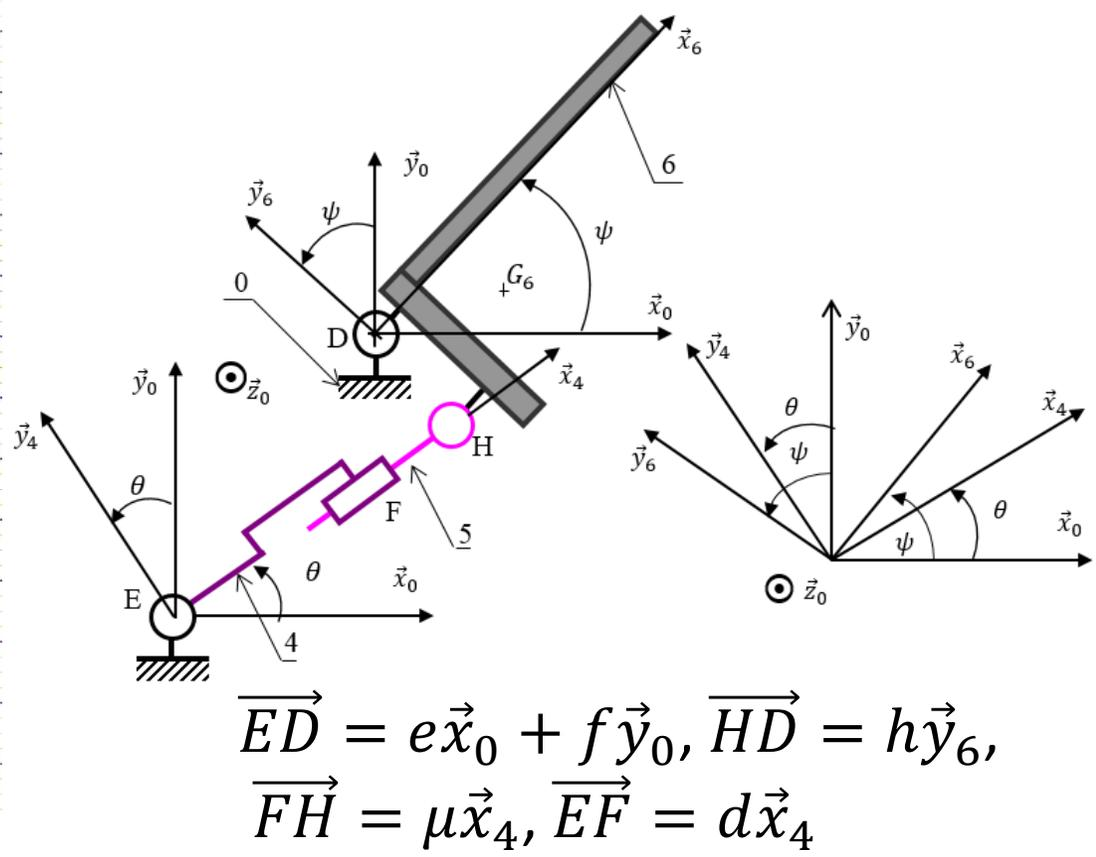
4. Exprimer dans la base du repère  $R_6$  les éléments de réduction du torseur dynamique du plateau 6 dans son mouvement par rapport à  $R_0$ .
