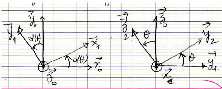
Déterminer le torseur cinématique de l'hélice 2 au point  $B$  dans son mouvement par rapport au bâti.
