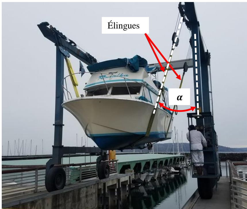
Figure 11. Maintien d'un bateau avec deux élingues.
